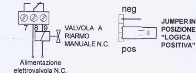
fig.4 Funzionamento logica positiva con valvola N.C.
